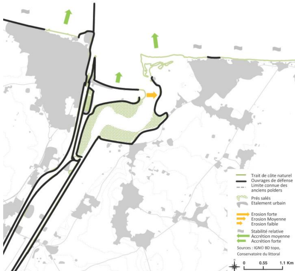
Figure 6 : dynamique sédimentaire et ouvrages de défense (CDL, 2014)
